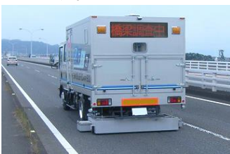
新技術の導入例 レーザ探査による 床版劣化状況の調査
