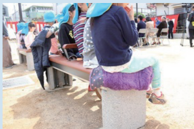
▲かまどベンチ 普段はベンチとして利用し、震災時は炊き出しに使用します。
