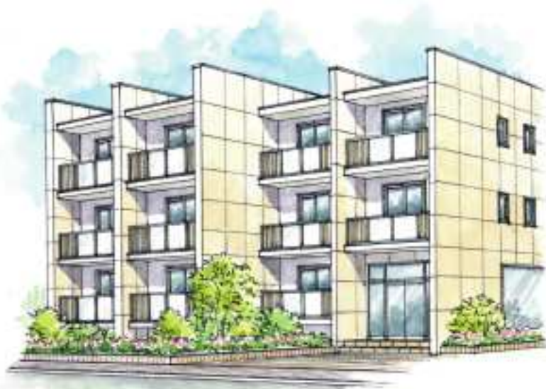
外壁の凹凸による分節
