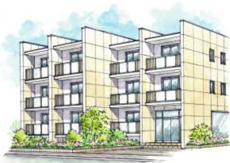
外壁の凹凸による分節
