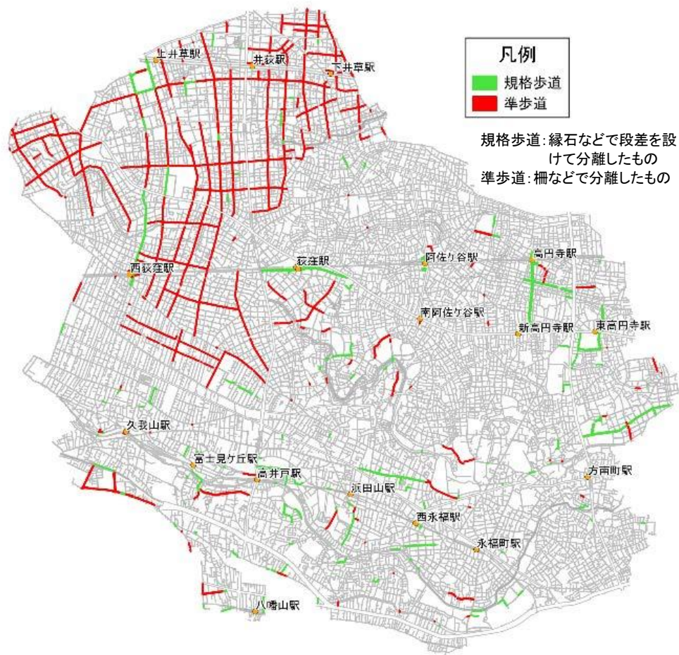
図 39 : 歩道設置箇所図 (区道)
